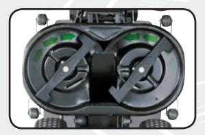
Die gegenläufig angetriebenen Windflügel-Messer schaufeln das Schnittgut direkt zur Mitte des Mähwerks in den Grasfang-Kanal. Kurze Wege in den Fangkorb unterstützen die hervorragenden Fangeigenschaften der LawnBoss-Traktoren.
