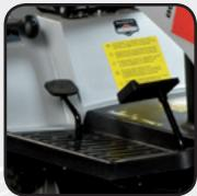
Die bequeme Hydrostatwippe im Fussraum der Traktoren ermöglichen leichte und stufenlose Richtungswechsel. Das geht nicht in den Fuss und hält länger wach.
