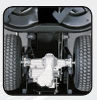
Starke Getriebe des Qualitätsherstellers HYDRO GEAR bringen den 5015-H nach vorn. Stufenlos lässt sich die Fahrgeschwindigkeit wählen. Das ist Komfort!
