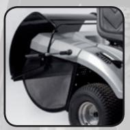
Ein Fangkorb mit denkbar leichter Entleerung. Ein Zug am Hebel und der Boden des Fangkorbs öffnet sich.
