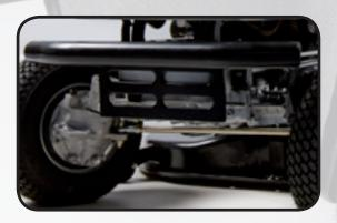
Die robuste Allradachse mit hydraulischer Syncronisierung sorgt für den richtigen Vortrieb im schwierigen Gelände. Die leichtgängige Servolenkung garantiert leichtes Handling.
